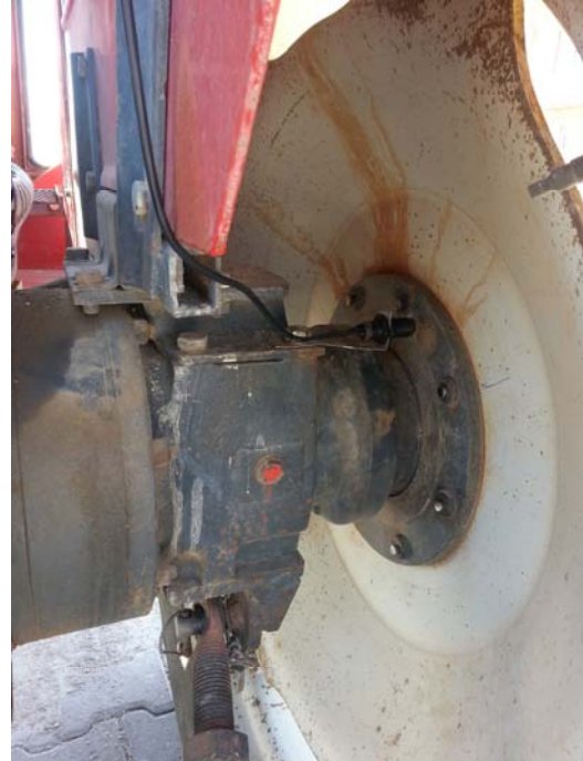
Şekil 5. Manyetik etki sensörü ve mıknatısların montajı
