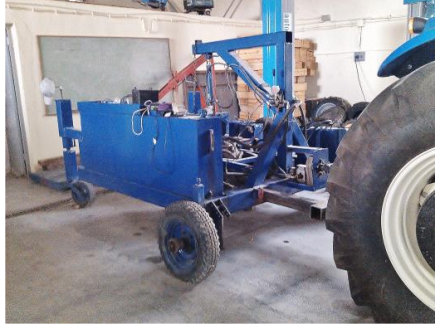
Şekil 2. Tek tekerlek test düzeneği.
