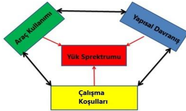
Şekil 1. Yük spektrumu parametreleri [5]
