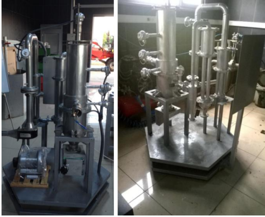
Şekil 8. Denemelerde kullanılan gazlaştırma reaktörü
