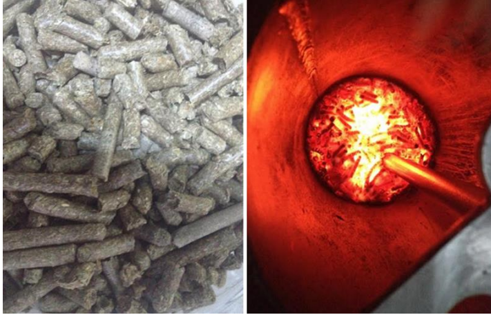
Şekil 13. Kanola peletleri ve reaktör iç görünümü
