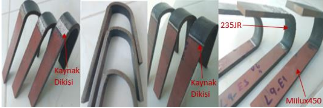
Şekil 6. Eğme testi sonucu eğilen kaynaklı numuneler
