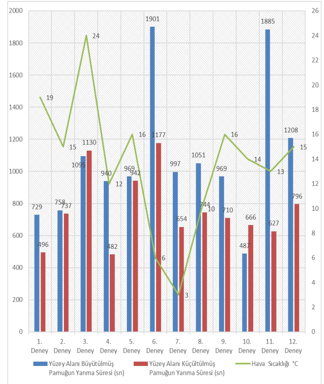
Şekil 14. İstanbul İlinde Yüzey alanı büyütülmüş ve yüzey alanı azaltılmış olan pamuğun havanın sıcaklığına bağlı yanma süreleri
