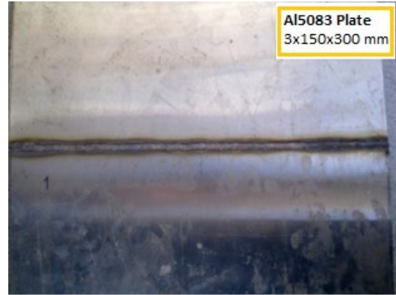
Şekil 3. Deney numunelerinin ölçüsü ve kaynak yapılış şekli
