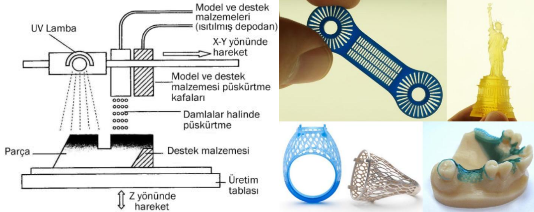
Şekil 8. MJM sisteminin çalışma prensibi ve bu yöntemle üretilmiş parçalar[18,22]
