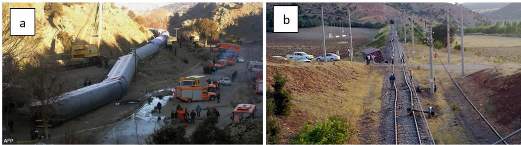
Şekil 2. a) Ray birleşim bölgesindeki kırılmayla ilişkilendirilen tren kazalarına dair örnek bir görsel [7] b) Termal burkulma hadiselerine dair örnek bir görsel [8]
