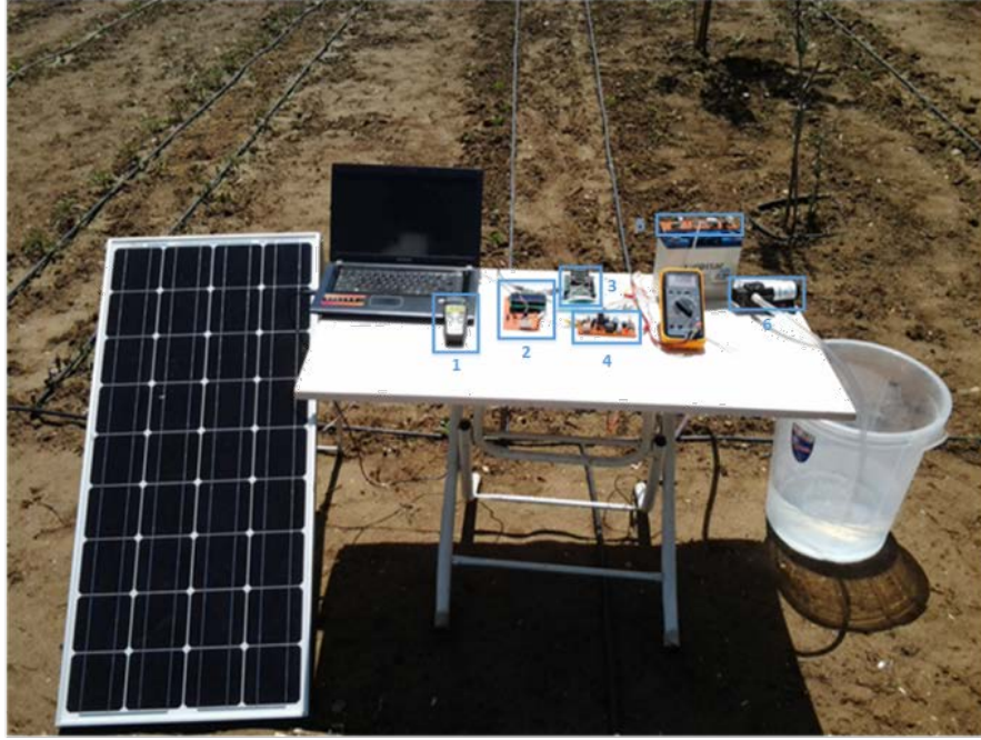
Şekil 7. PV panelin sisteme MGNI ile bağlı olduğu deney düzeneği
