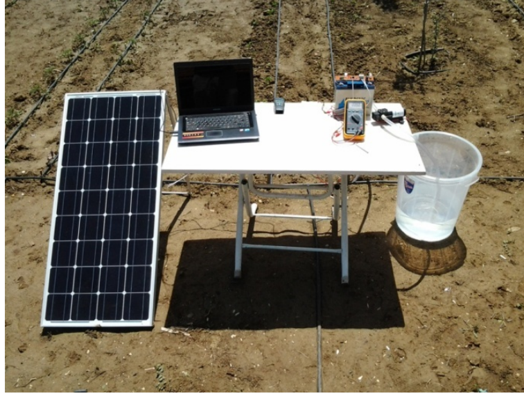
Şekil 8. PV panelin sisteme direk bağı olduğu deney düzeneğı
