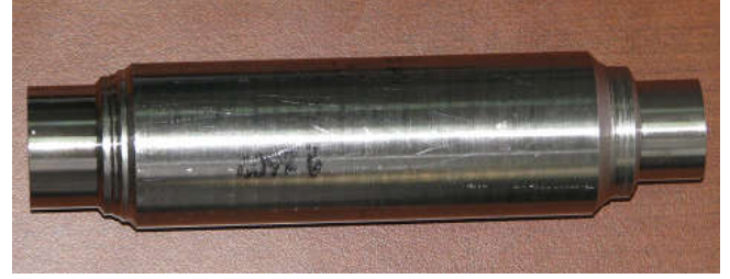
Şekil 1. ASTM B574 (Hastelloy C-22) malzemesi
