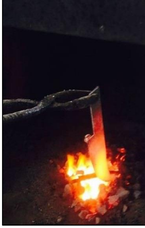
Fotoğraf 16: Bıçağın ısıtılması Fotoğraf 17: Isıtılıp işlenmiş bıçak Fotoğraf 18: Çeliğe su verilmesi
