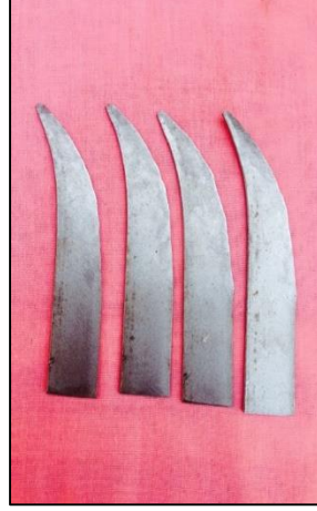
Fotoğraf 16: Bıçağın ısıtılması Fotoğraf 17: Isıtılıp işlenmiş bıçak Fotoğraf 18: Çeliğe su verilmesi
