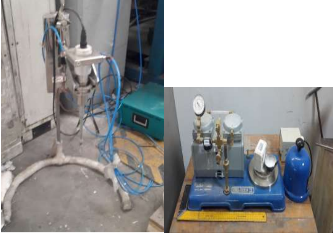
Şekil 2. (a) Ultrasonik gaz giderme cihazı ve (b)VAK(Vakum Altında Katılaştırma=RPT) cihazı (Figure 2. (a) Ultrasonik degassing equipment, (b) Reduced Pressure Test Equipment)
