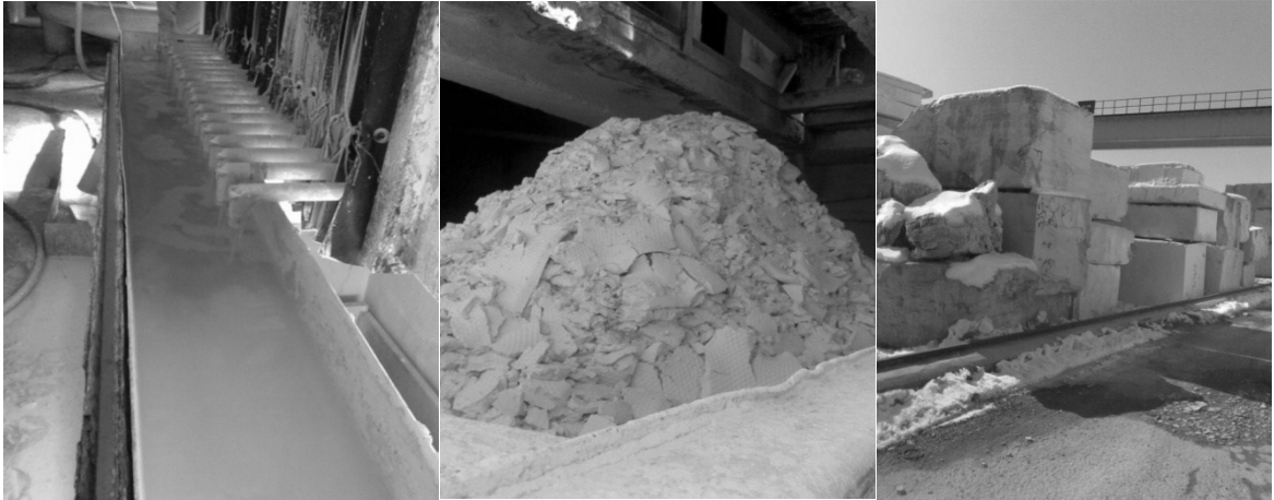
Şekil 1. Traverten ve mermer tozunun sudan ayrılmış ve blok hali (Foto.Çelikbaş ve Aykaç)
