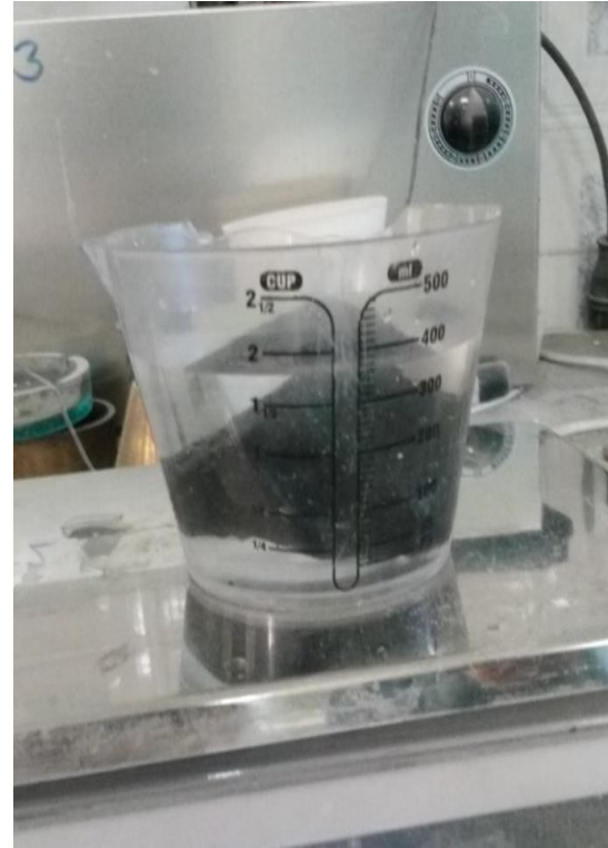
Şekil 11. Numunenin hacminin ölçülmesi
