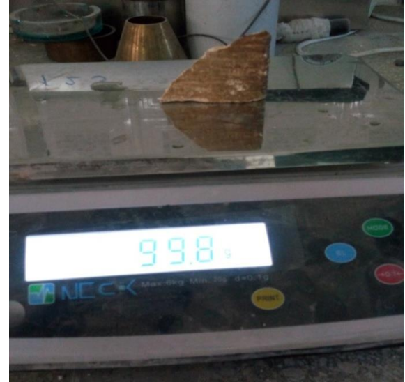
Şekil 10. Numunenin ağırlığının ölçülmesi
