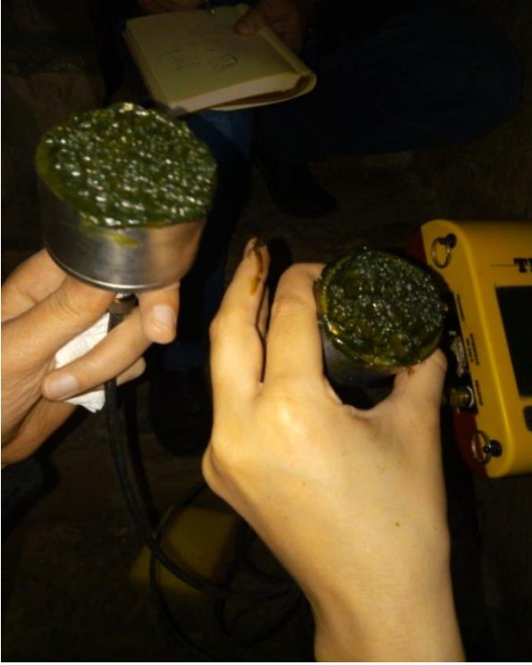
Şekil 7. Ultrasonik test cihazı prob başlıkları
