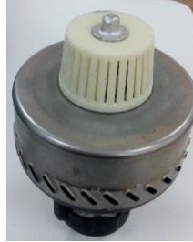
Şekil 7. Yatay şekilde üretilen seperatörün motora montaj edilmesi
