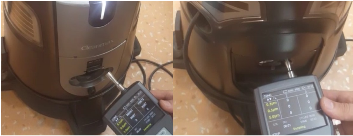
Şekil 16. (a) Cihaz giriş partikül seviyesi (b) Cihaz çıkış partikül seviyesi
