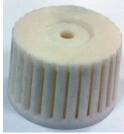
Şekil 10. Seperatörün yatay üretilmiş hali
