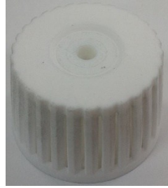
Şekil 13. SLS yöntemiyle üretilen seperatör parçası
