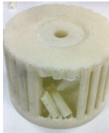
Şekil 12. Yatay şekilde üretilen seperatörün kırılan kanatların görünmesi
