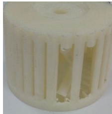
Şekil 8. Yatay şekilde üretilen seperatörün kırılan kanatların görünmesi
