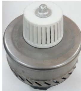
Şekil 14. SLS üretilen seperatörün motora montaj edilmesi
