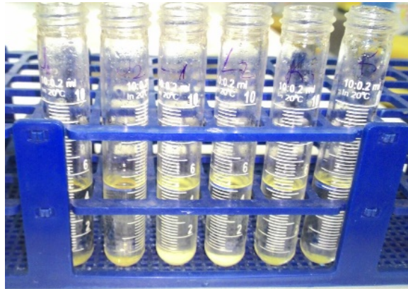
Şekil 2: Kakao yağına 0,05 g eklenen proteinlerin 30oC'de 24 saat bekletildikten ve santrifüjlendikten sonraki görüntüsü (Soldan sağa sırasıyla tüplerin protein içerikleri: 1. ve 2. tüpler: jelatin; 3. ve 4. tüpler laktalbumin; 5. ve 6. tüpler kazein)
