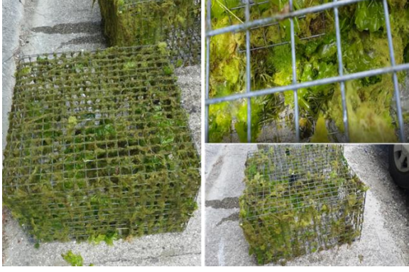
Şekil 3. Akıntı sebebiyle alglerle kaplanmış sepetler
