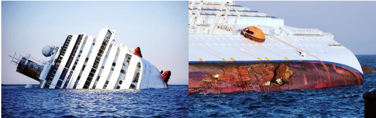
Şekil 2. Costa Concordia yolcu gemisinin karıştığı kazada karina hasarı alarak kısmen batması ve yatması [20, 21].
