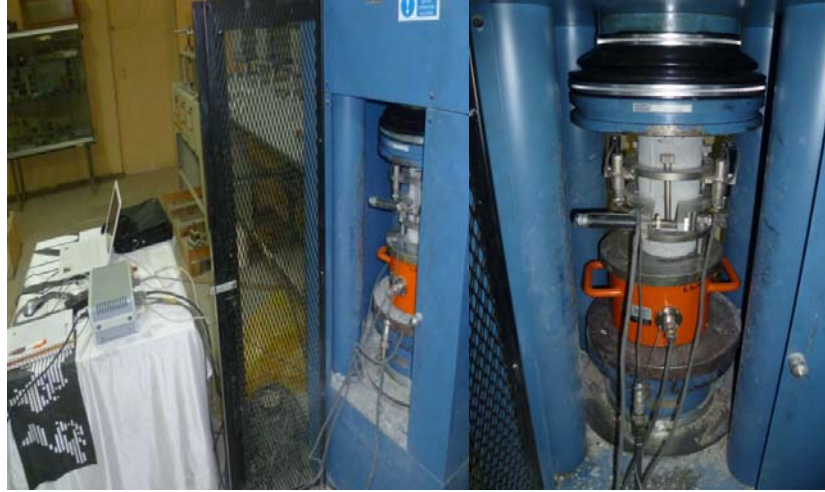
Şekil 4. Elastisite modül belirlemede deney düzenegi
