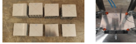
Şekil 1. Üretilen numuneler ve numunelerin deney cihazına bağlanması (Produced samples and the samples to connected test device)
