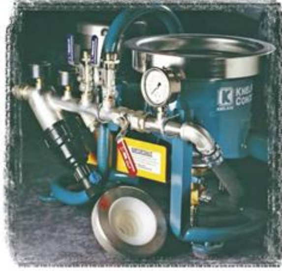
Şekil 4. Deneysel çalışmalardan kullanılan KC-MD3 Knelson Konsantratör [20].
