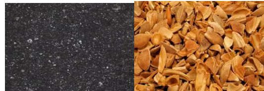
Linyit kömür tozu Şeftali çekirdeği Şekil 1. Denemelerde kullanılan şeftali çekirdeği ve linyit kömür tozu
