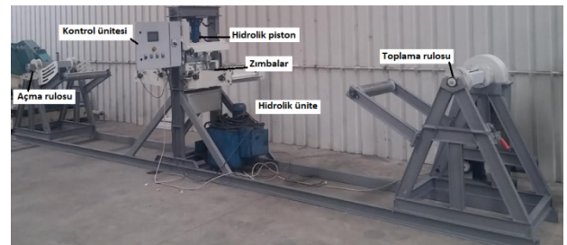
Şekil 5. İmalatı gerçekleştirilen otomatik bant delme makinesi
