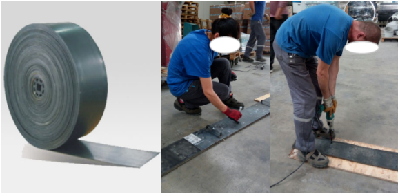
Şekil 3. Bant üzerindeki deliklerin işaretlenmesi ve delinmesi
