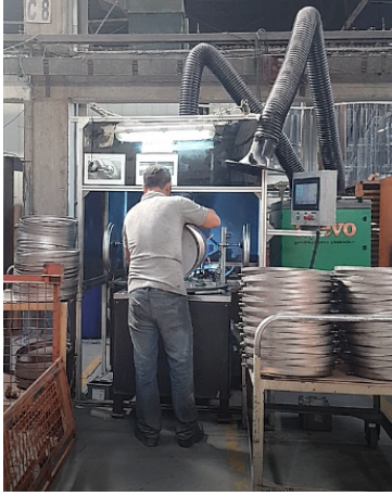
Şekil 4. Alt Kapağın Kaynak Robotuna Yerleştirilmesi
