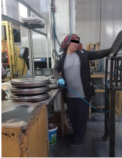
Şekil 7. Ventil Delişine Boru Takılarak Azot Dolumu
