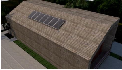
Şekil 6: Çatıda ek strüktür ile kullanılan FV panel uygulaması (Çatı-1)
