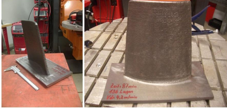
Şekil 7. TAEİ yöntemiyle üretilen kanat şekilli parça [12].
