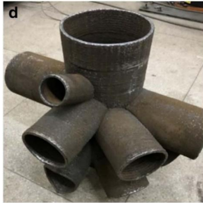
Şekil 10. 10 yönlü boru bağlantısı [21].
