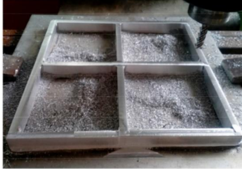
Şekil 8. Hibrit yöntemle üretilen takviye paneli [11].
