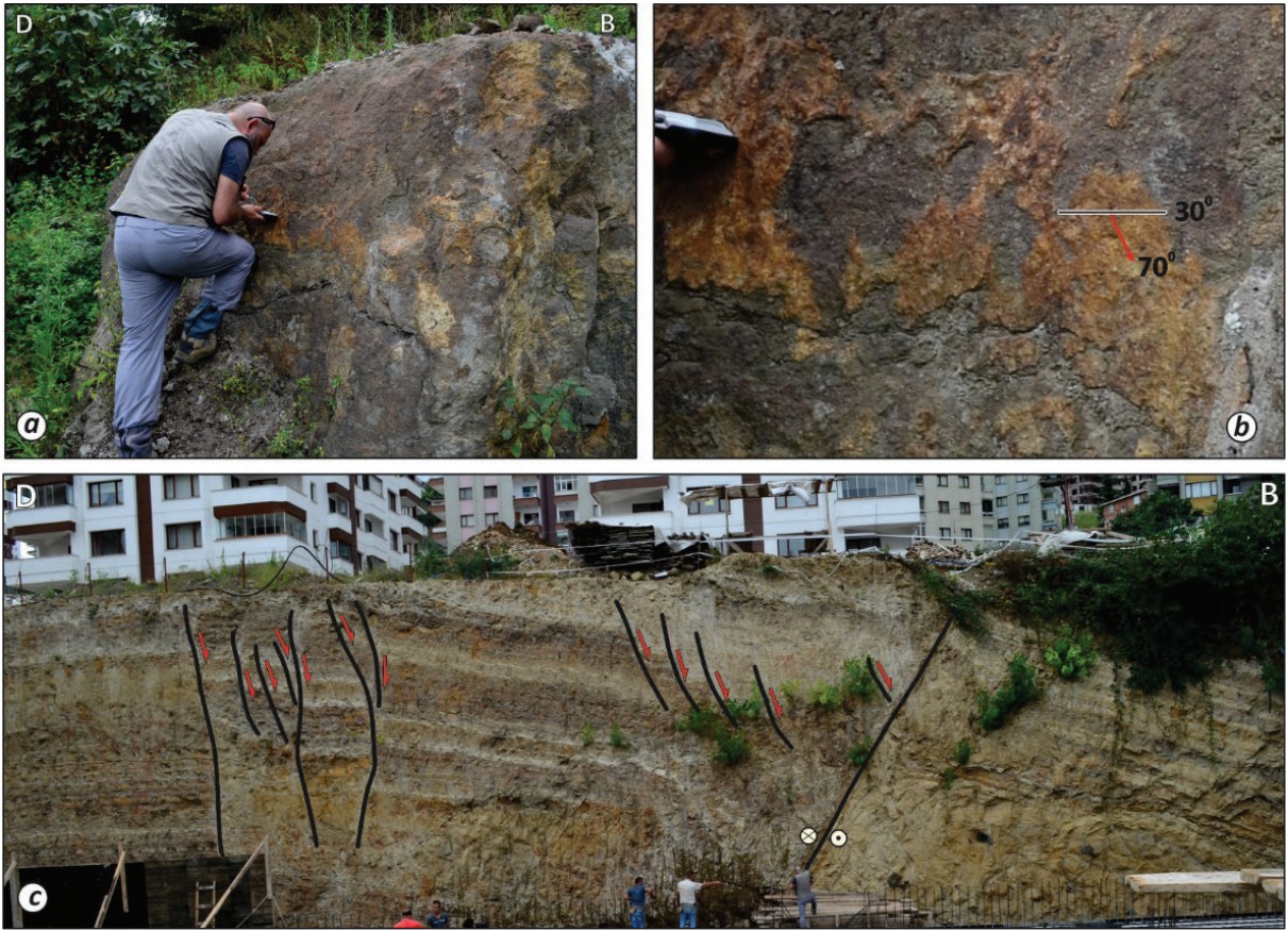
Şekil 9. (a, b, c) Pliyosen yaşlı tortul birimler içerisinde eğim atımlı normal faylanma ve doğrultu atımlı faylara ait kinematik gözlemler (a-b: 52350D/39500K, c: 52346D/39800K).
