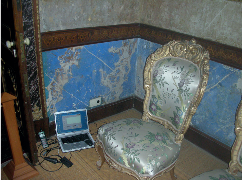
G.1 Saray ortamında bađıl nem ve sıcaklık izlemesi - Spot analiz (A. Kuzucuođlu Arřivi)
