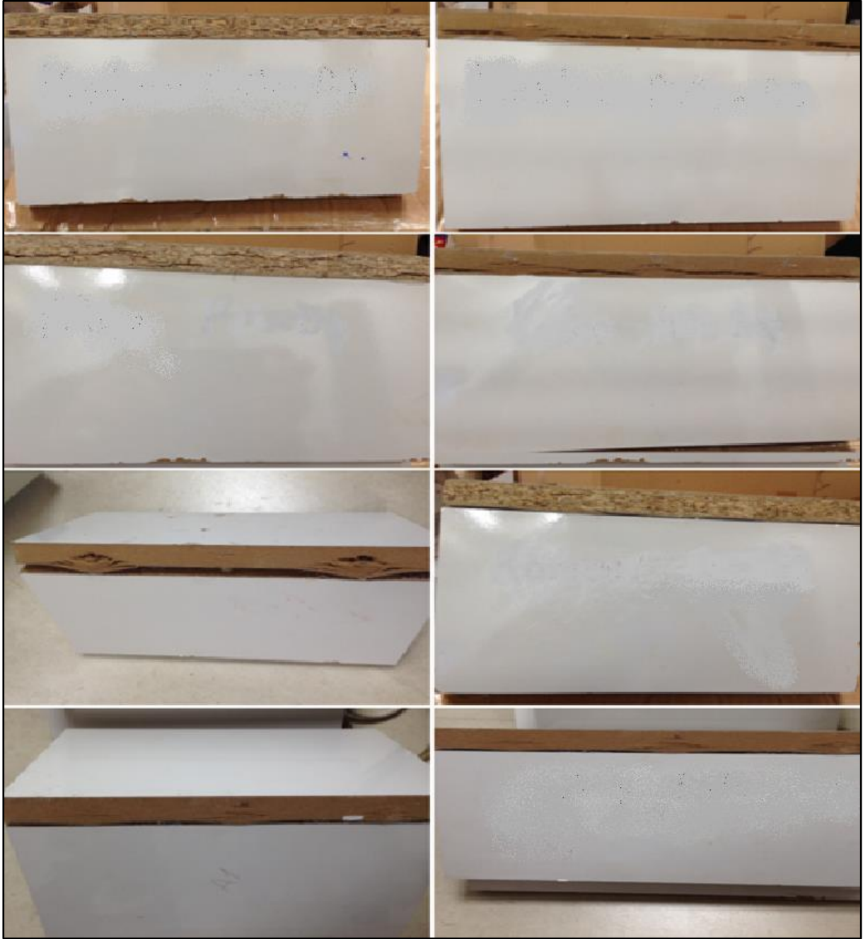
Şekil 4. Yük uygulaması sonucu oluşan deformasyonlar
