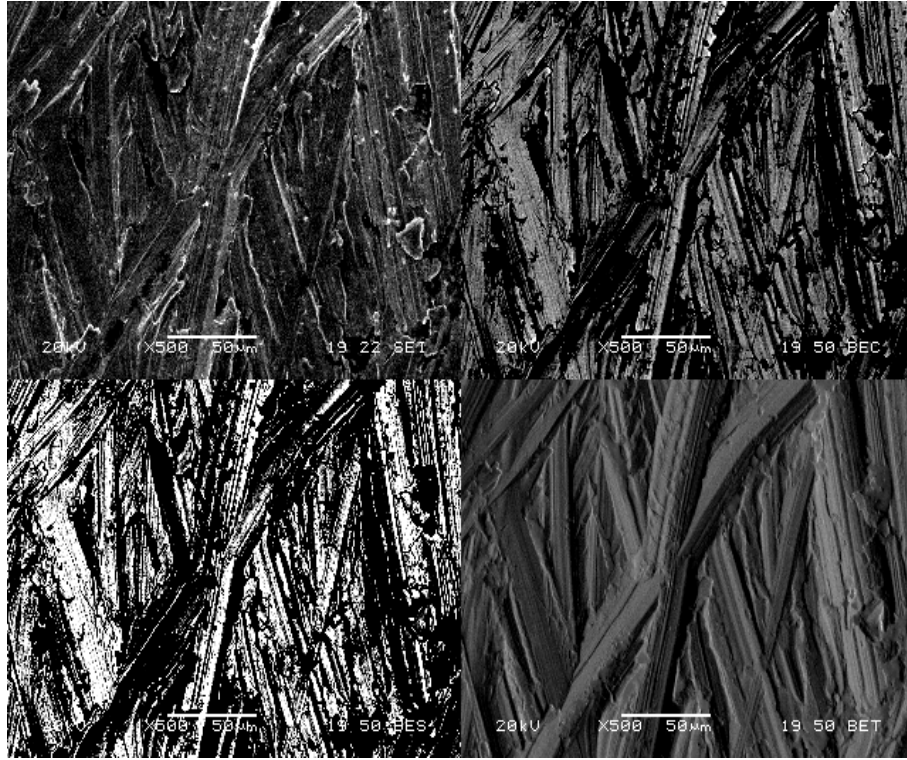
Şekil 12. B4 kodlu numune 15 N yük altında aşınma SEM ve BSEM görüntüleri
