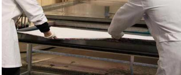
Resim 19. Halının boyayı emdikten sonra teknedeki çıkartılması işlemi
