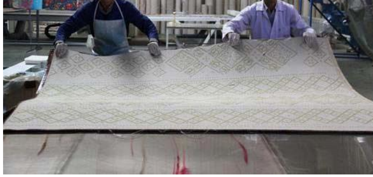
Resim 21. Desenli akrilik halının tekne içine yerleştirilmesi
