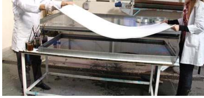
Resim 17. Düz renkli akrilik halının tekne içine yerleştirilmesi
