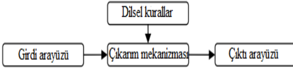
Şekil 3: Bulanık Mantık Sisteminin Temel Yapısı
