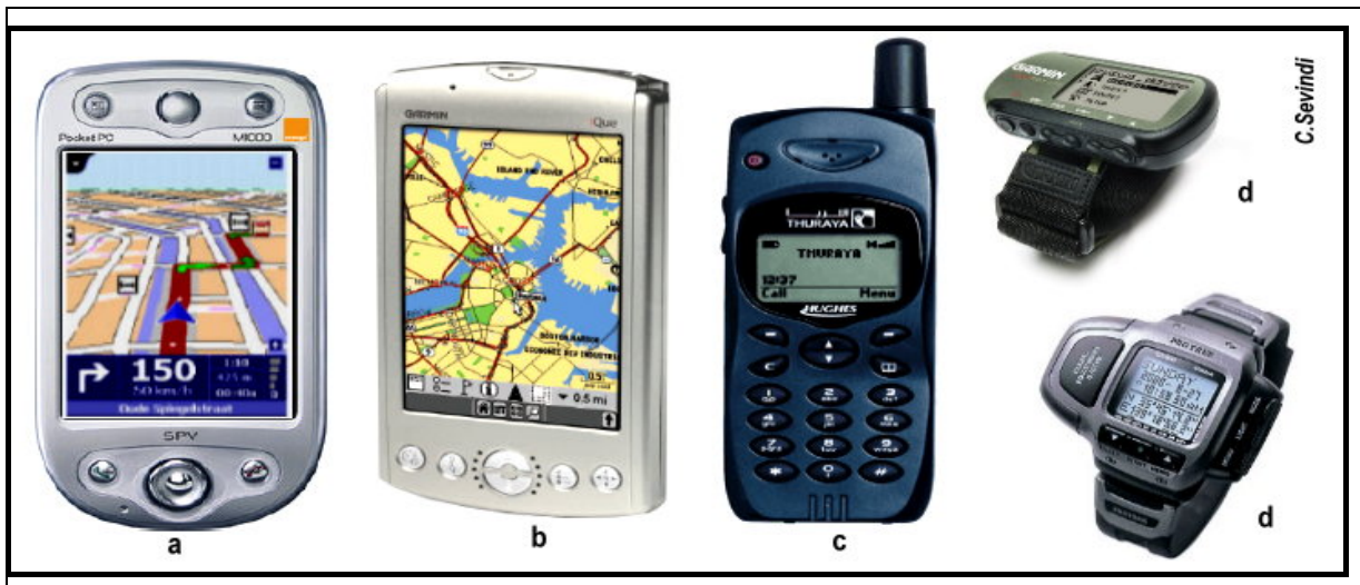
Fotoğraf 4. GPS sinyallerini yorumlayabilen elektronik araçlar a)-Pocket-PC b)-PDA cihazı c)-Cep telefonu d)-Kol saatleri
