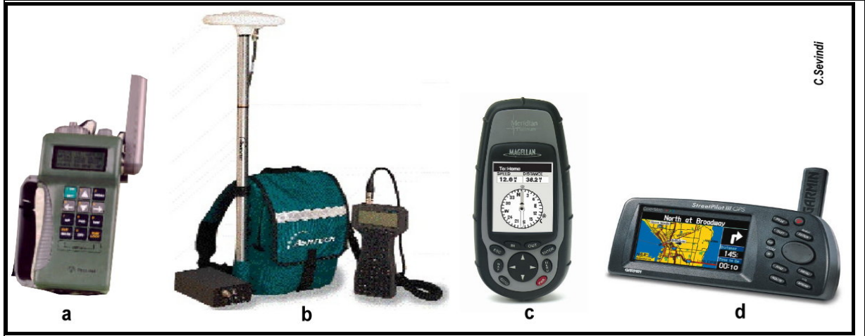
Fotoğraf 2. GPS alıcıları a)-P-Kod yorumlayabilen askeri amaçlı GPS b)-Jeodezik amaçlı GPS c)-Sivil kullanıcı portatif el GPS'i d)-Renkli ekran portatif el GPS'i .
