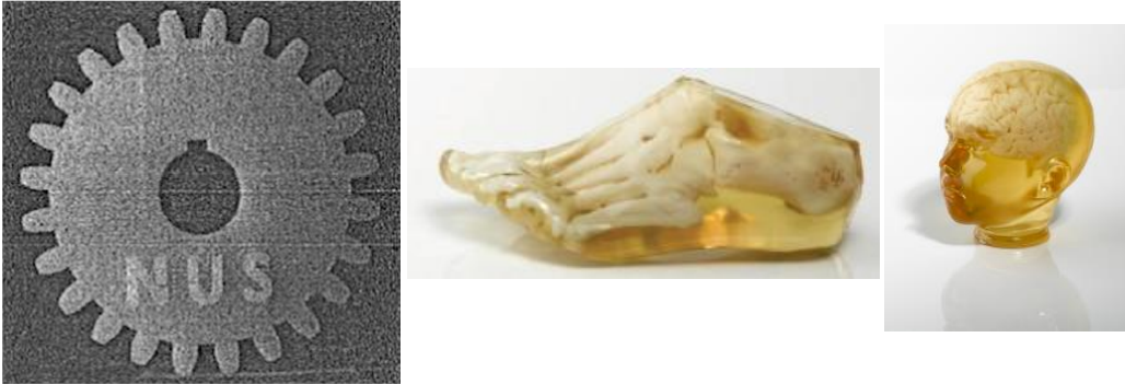
Şekil 13. MJM ile üretilmiş balmumu dişli ve akrilik fotopolimer medikal modeller [28,33]. (Figure 13. Wax gear and acrylic photopolymer models fabricated by multi jet modelling)
