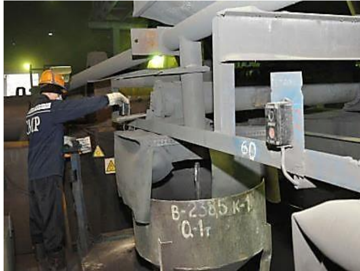
Şekil 14. Molibden konsantrelerinin harmanlama işlemi
