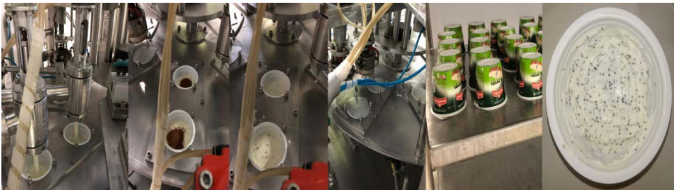
Şekil 3. Mavi haşhaş tohumu katkılı krem peynirlerin üretimi
