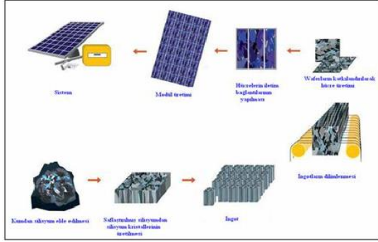
Şekil 2. Güneş pilinden modüle kadar üretim aşamaları (www.yegm.gov.tr, 2019)
