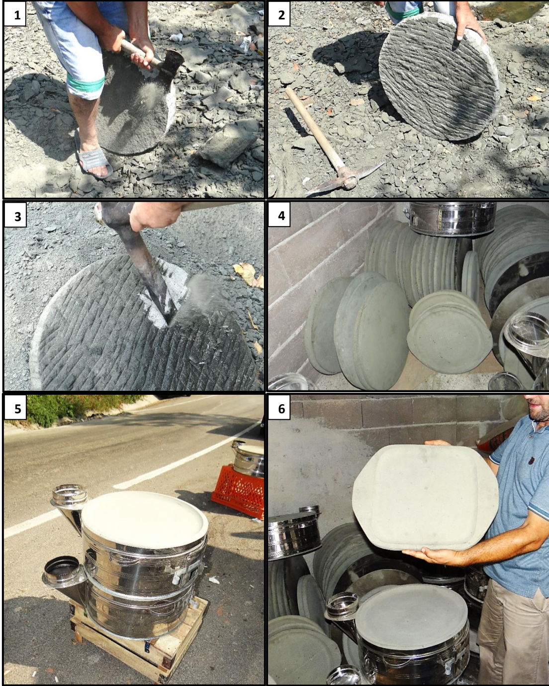
Fotoğraf 3: Bartın Taş Sac işleme aşamaları: 1: Taş sacın kaba yontulması; 2: Kaba yontma işlemi tamamlanmış sac; 3: Islatıldıktan sonra yapılan ince yontma; 4: Zımpara işlemi yapılarak istiflenmiş taş saclar; 5: Yol kenarlarında satışa sunulan sobalı taş sac örnekleri; 6: Bartın taş sacının farklı tasarımlarından bir örnek
