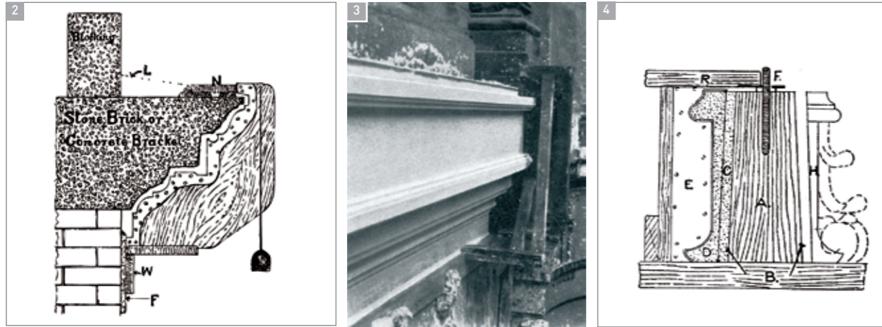
Şekil 2, 3 ve 4. Çimentolu harçlarla çekme kalıp uygulaması (sol: Millar, 2004; s. 186; ve orta: Lade ve Winkler, 1955; s. 161) ve Korent düzeninde sütun başlığı çekilmesi (A ahşap çekirdek, B tezgah, C kaba sıva çekirdek, D ince sıva gövde, E çekme kalıp, R yarıçap çubuğu, F merkez pimi, H gövde üzerine daha sonra yerleştirilecek yaprak vb. parçalar; sağ: Millar, 2004; s. 298)
