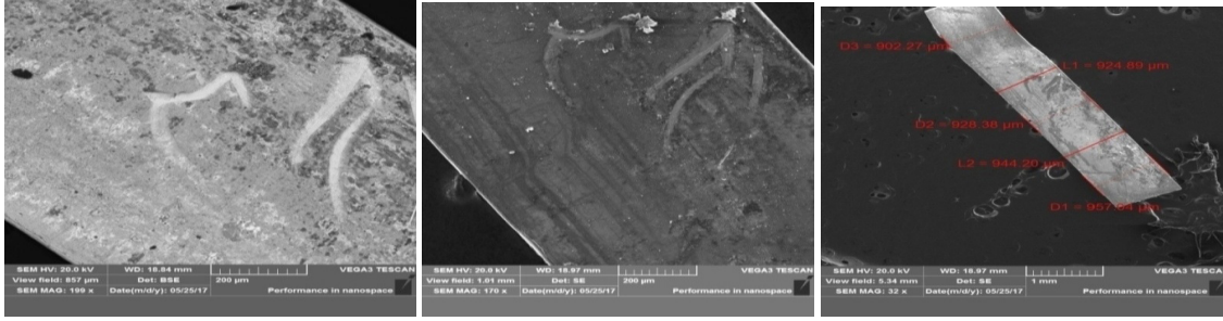
Şekil 3. 591 envanter numaralı peştemalde ki telin SEM görüntüsü ve genişlik değeri
