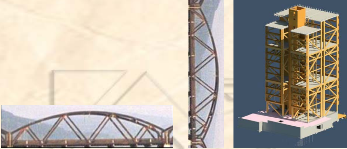
Şekil 10. The Tree yapısı taşıyıcı sistem kurgusu (Abrahamsen, 2015).
