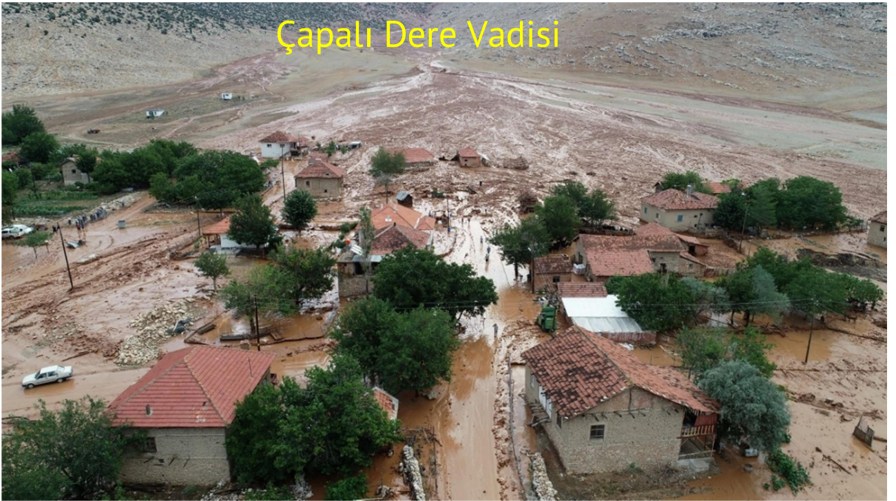
Foto 1. Salur kırsal mahallesinde gerekleřen amur akıntısı. Fotoęraftan da anlařılacaęı zere yerleřme, akarsu vadisinin ovaya aıldıęı yerdeki birikinti konisini oluřturan depoların zerinde kurulmuřtur.
