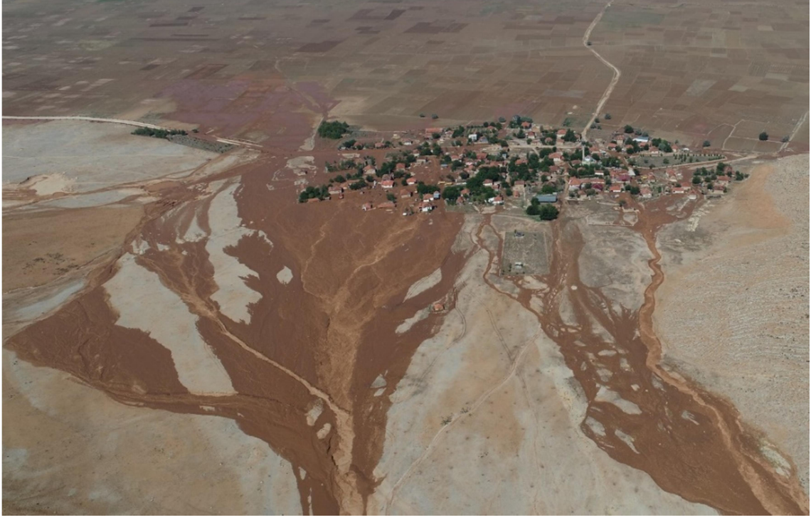
Foto 2. Salur kırsal mahallesinde gerekleřen amur akıntısı (Batıdan dođuya bakıř). Yerleřmenin akarsu havzasının ařađı kesimine ve birikinti konisi zerine kurulmuř olması, kısa zamanda gerekleřen sađnak yađıřlar nedeniyle akarsuyun sel karakterli akıř gstermesine ve afetin olumsuz etkilerinin artmasına neden olmuřtur.
