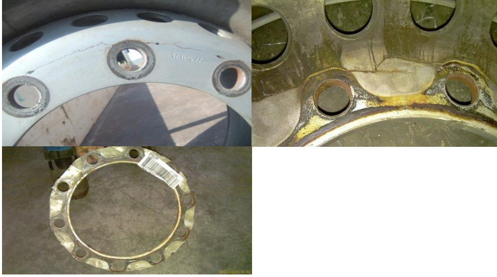
Şekil 2. Test makinesinde jantın kırılma bölgeleri
