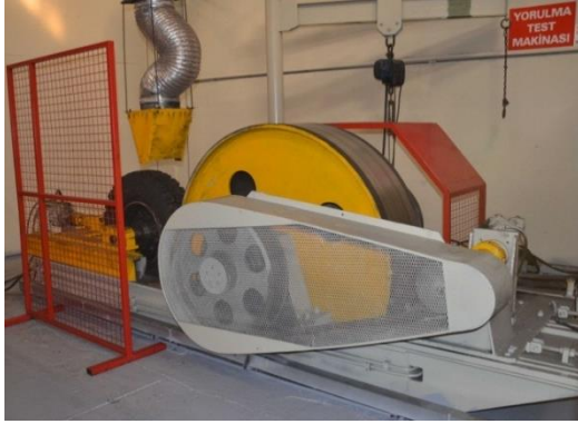
Şekil 1. Dinamik radyal yorulma test makinesi
