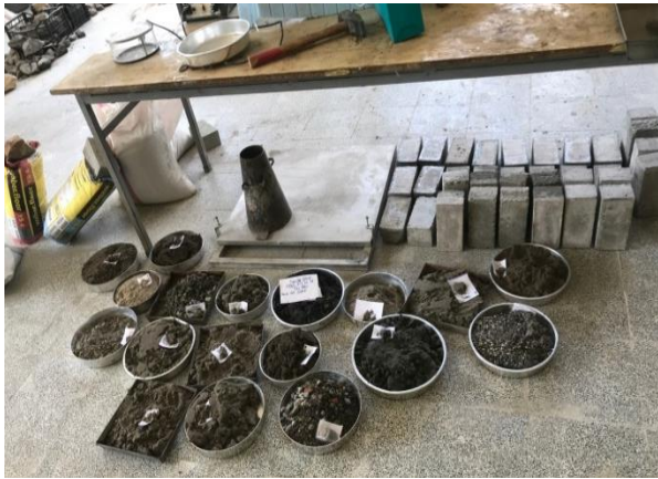
Şekil 3. Numunelerin Etüve İçin Hazırlanması
