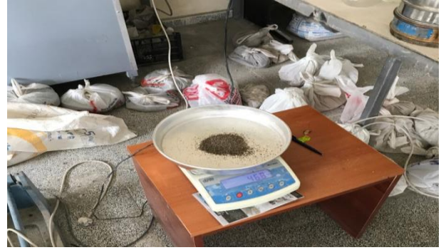
Şekil 4. Numunelerin Hassas Terazide Tartılması
