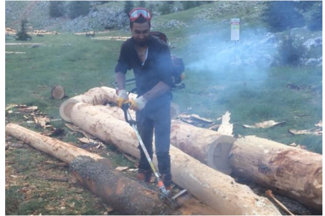
Şekil 7. Motosoyarla çalışma sırasında egzoz dumanı yayılımı
