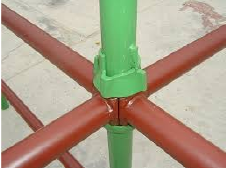
Şekil 9: Fincanlı İskele Kesit
