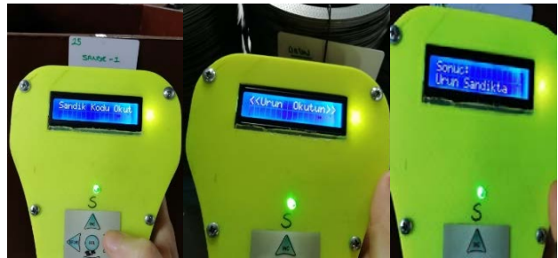
Şekil 4. Ürün etiketi ve sandık etiketinin okuma sistem tasarımı.
