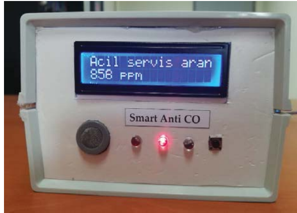
Şekil 9. CO Gaz Yoğunluğunun 800 ppm'in Üstünde Olması Durumu
