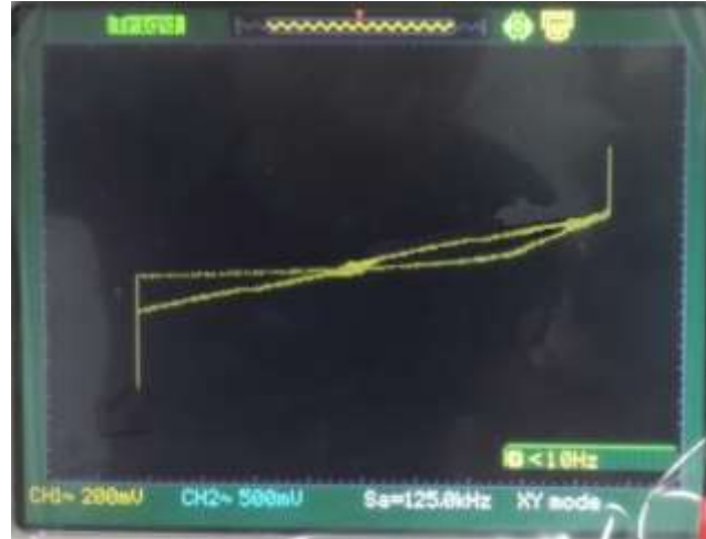
Şekil 8. 8 Hz sinüsoidal gerilimle beslenen memristör taklitçisinin histeresis eğrisi
